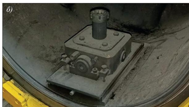
Рис. 2. Юстировочный механизм (а); юстировочный механизм после 200 подрывов (б)
